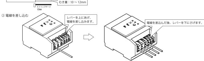
※電線が単線の場合は、端子台のレバーを上げずに差し込むだけで配線できます。
