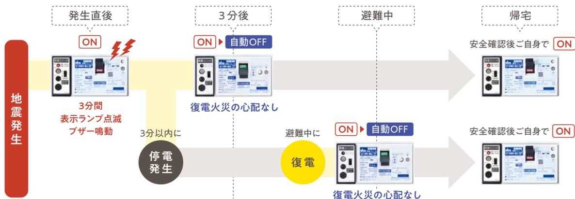
■遮断時間「即」設定時に地震波感知した場合、表示ランプ点滅・ブザー鳴動を行わずブレーカを即時遮断します。
