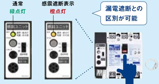
地震波感知により遮断した場合、ブレーカ投入時、表示ランプが(約10秒間)橙色に点灯。
